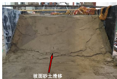
(b) 坡面土体滑移
